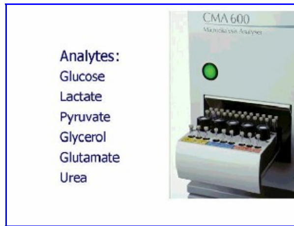
Fig. 5. Equipo de microdiálisis cerebral, y los metabolitos posibles de ser mensurados.
